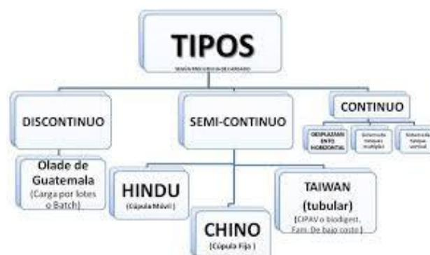
Figura 1 Tipos de biodigestores
