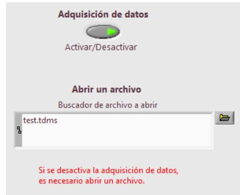
**Figura 15** Control para activar/desactivar la adquisición de datos en tiempo real y buscador de archivos
