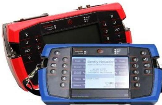
**Figura 1** Analizador de vibraciones portátil
