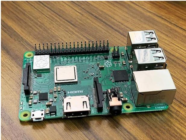
**Figura 6** Ordenador de placa Raspberry Pi 3
