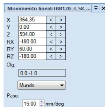
**Figura 3** Valores de la posición, rotación y configuración de robot
