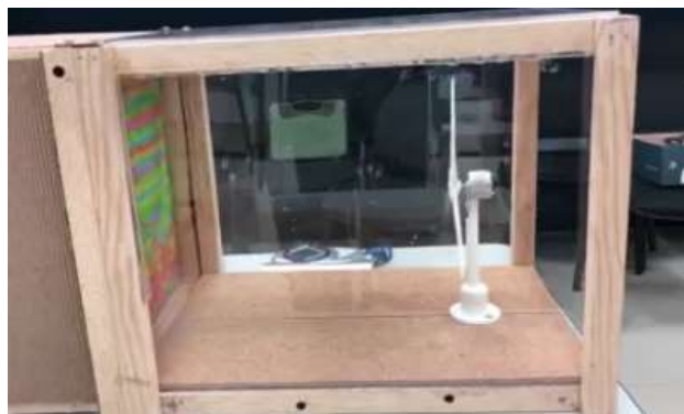
Figura 5 Cámara de pruebas del túnel de viento Fuente: Elaboración Propia
