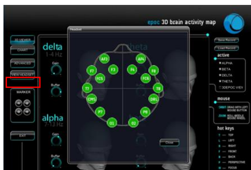
Figura 2 Emotiv 3D Brain Activity Map mostrando buena conexión en todos los canales de comunicación
