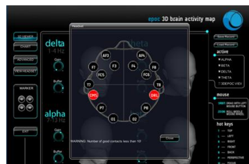
Figura 1 Emotiv 3D Brain Activity Map mostrando nula conexión en los electrodos
