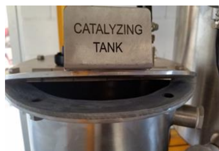
Figura 4 Colocación de la mezcla en tanque para reactivos
