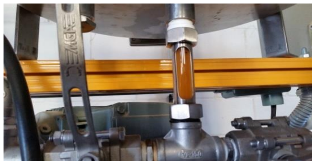
Figura 7 Lavado y separación de la glicerina del biodiesel Fuente: Elaboración Propia
