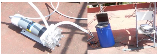
Figura 7 Bomba peristáltica y SAD
