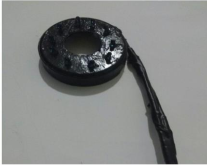
Figura 3 Estructura con arreglo de LEDs terminada Fuente: Elaboración Propia
