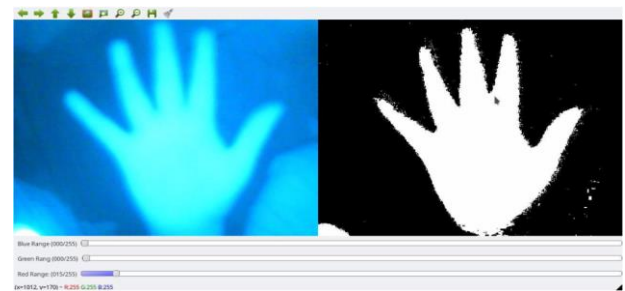
Figura 5 Asignación de umbral para el canal con el color rojo y segmentado con esa información Fuente: Elaboración Propia
