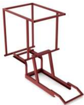
Figura 4 Modelado 3D del Diseño del chasis del minitractor
