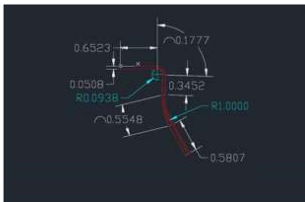
Figura 2 Dimensionamiento de pieza Contacto Auxiliar
