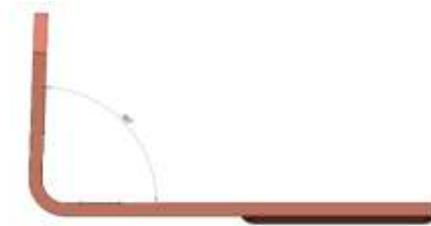
Figura 25 Doblez a 88° en pieza “contacto auxiliar”
