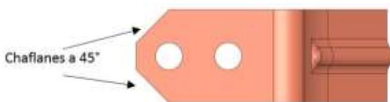
Figura 23 Chaflanes a 45° en pieza “contacto auxiliar”
