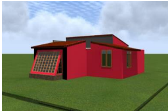
Figura 2 Modelo volumétrico de la vivienda donde se incorporó el elemento bioclimático pasivo (muro trombe)
