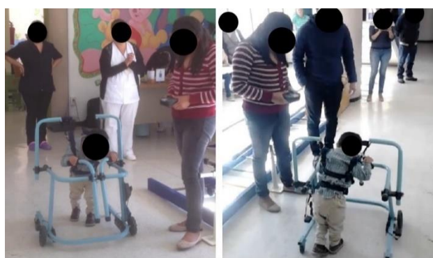
Figura 8 Vistas fotográficas frontal y posterior de la rutina de la asistencia motriz a un menor durante el ciclo de marcha mediante el sistema mecatrónico en un ambiente real
