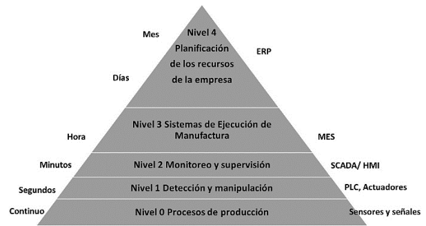
Figura 4 Los niveles de automatización Fuente: Adaptación de Norma ISA - 95
