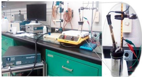
Figura 5 Celda electroquímica de 3 electrodos. A) Esquemática, B) Celda empleada
