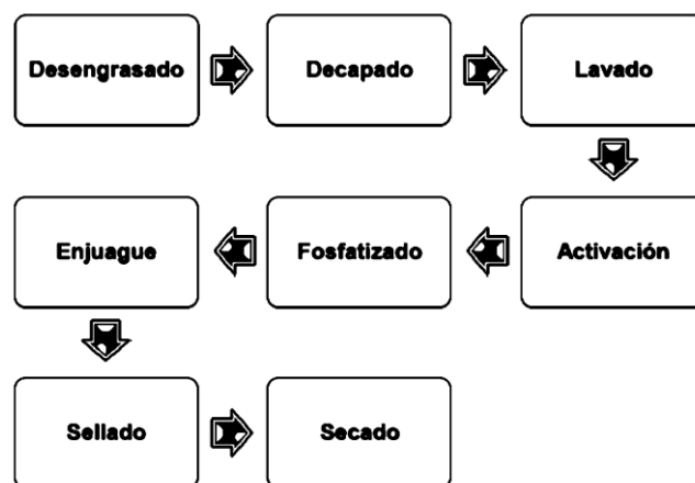
Figura 4 Secuencia de fosfatizado mediante el método de inmersión [3]
