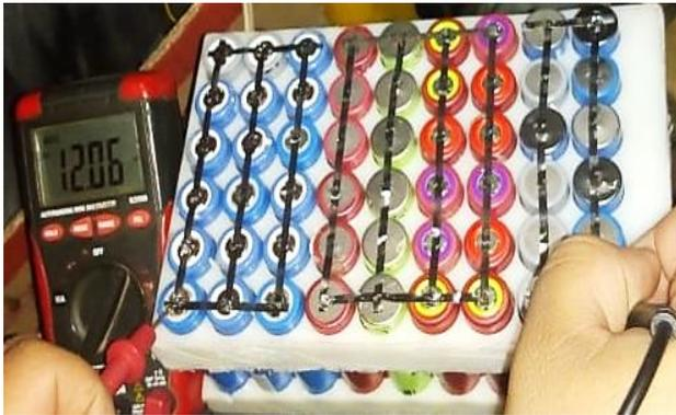
**Figura 4** Circuito Serie-Paralelo de celdas de batería
