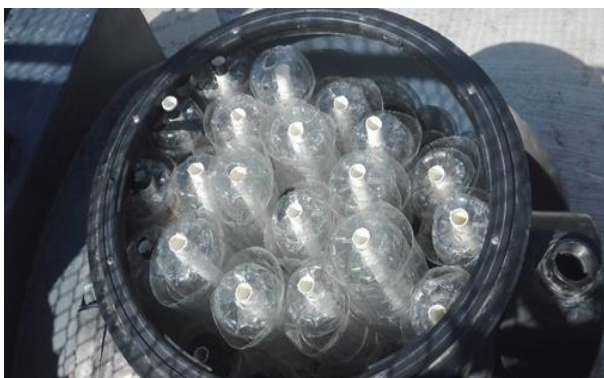
Figura 4 Vista superior del reactor con la estructura con pvc y botellas PET
