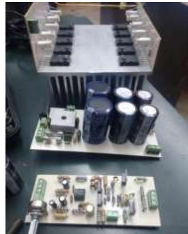
Figura 5 Las 3 etapas del amplificador de audio proyecto
