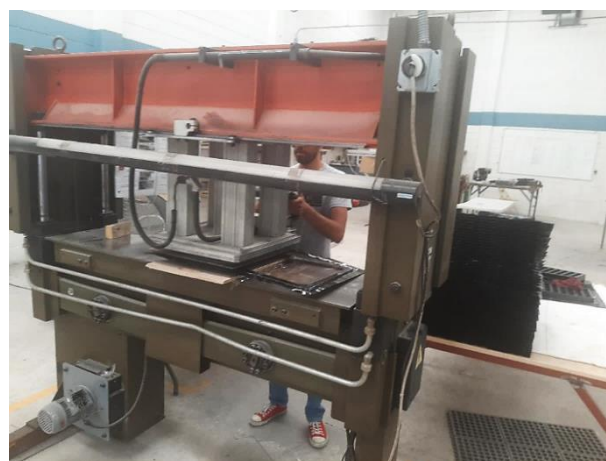
Figura 3 Máquina cortadora de charolas Harman
