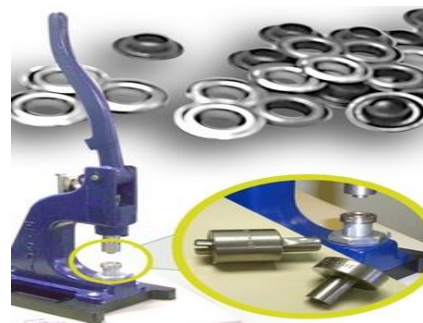
Figura 4 Remachadora textil manual con mecanismo de dados.
