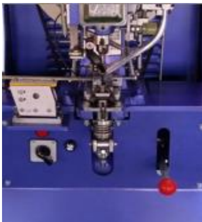
Figura 7 Mecanismo automático para remache de ojillo macho y ojillo hembra
