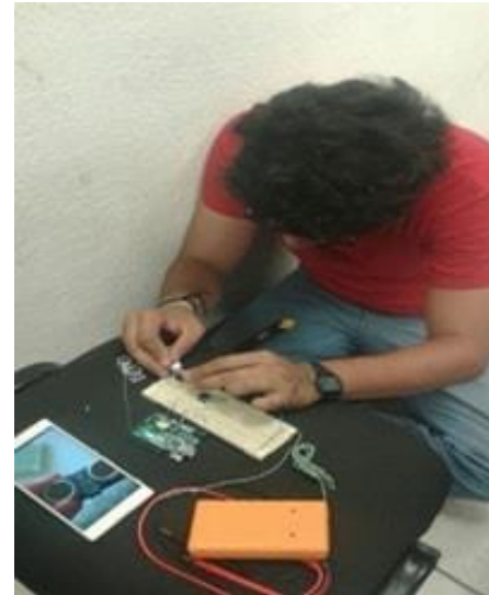
Figura 9 Armado de control con sensores mq7 y bmp85 Fuente: Elaboración propia, desarrollo experimental para el concurso CANSAT CUCEI 2017
