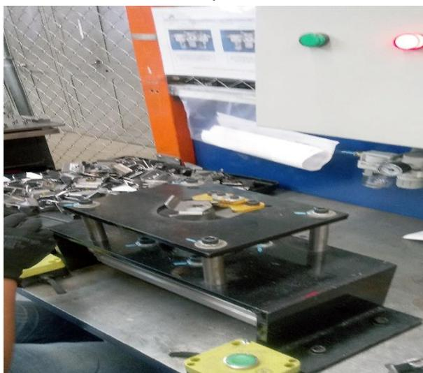
Figura 10 Poka yoke para prueba de torsión
