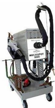
**Figura 3** Equipo para soldadura por puntos manual
