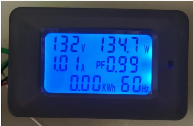
Figura 17 Conexión de un medidor comercial para comparar con el medidor bidireccional Fuente: Elaboración Propia
