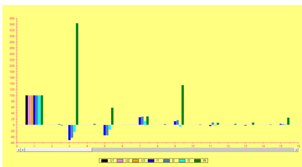
Figura 46 Espectro de frecuencias del sistema eléctrico con el SFV conectado a él Fuente: Elaboración Propia
