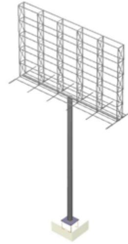
**Figura 6** Modelo 3D analizado en Ram Elements 13.5
