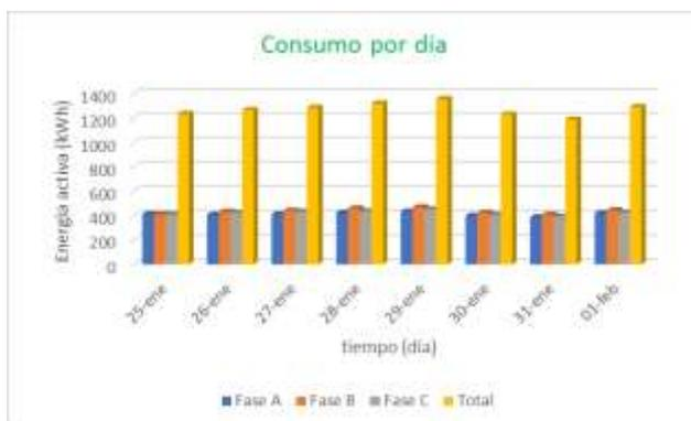
**Figura 8** Consumo total, presentado en barras, durante los días de medición en el sistema eléctrico de la Congeladora
