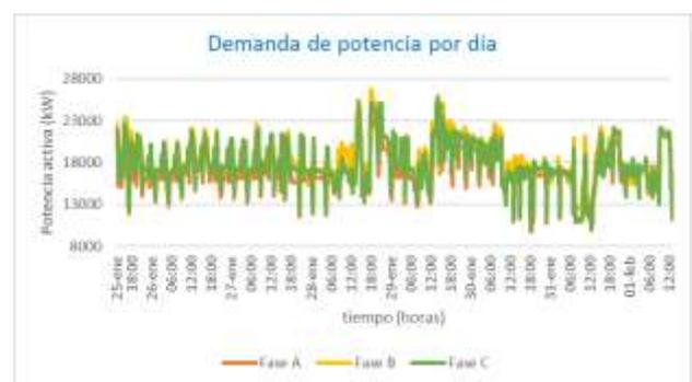
**Figura 7** Potencia máxima por día que demanda la instalación eléctrica de la congeladora
