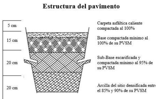
**Figura 7** Estructura del pavimento
