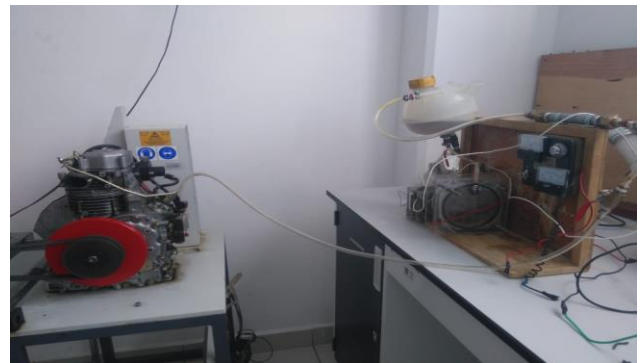
Figura 14 Motor MERLIN2 alimentado con la producción de hidrógeno de celdas secas en conexión paralela
