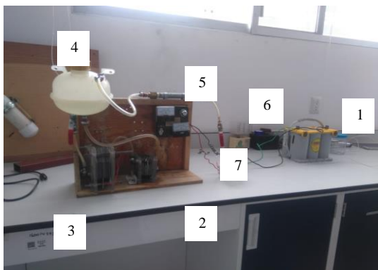
Figura 7 Celdas secas conectadas en serie. (1: batería 12V 450cca, 2 y 3: Celdas secas, 4: recipiente de balance de 1.6 lt, 5: supresor de flamas, 6: manguera de salida de hidrógeno, 7: voltímetro y amperímetro.)
