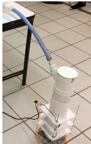
**Figura 5** Sección de trampa de sólidos y extractores
