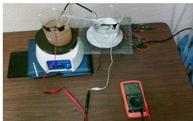
Figura 1 Prototipo de celda eléctrica con extracto de clorofila y una solución de ZnCl 2
