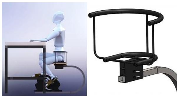
Figura 4 Diseño con sandalias y estructura más ligera con ajustes
