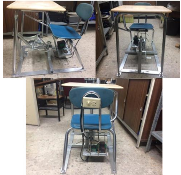
Figura 1 Primer diseño con butaca y cuadro de bicicleta
