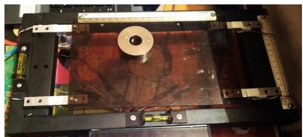
Figura 5 Prueba con una distancia de 8 cm y 4 cm con una fuerza de 2N
