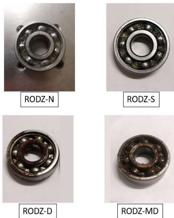
Figura 1 Muestras seleccionadas de Rodamientos en Diferentes etapas de desgaste
