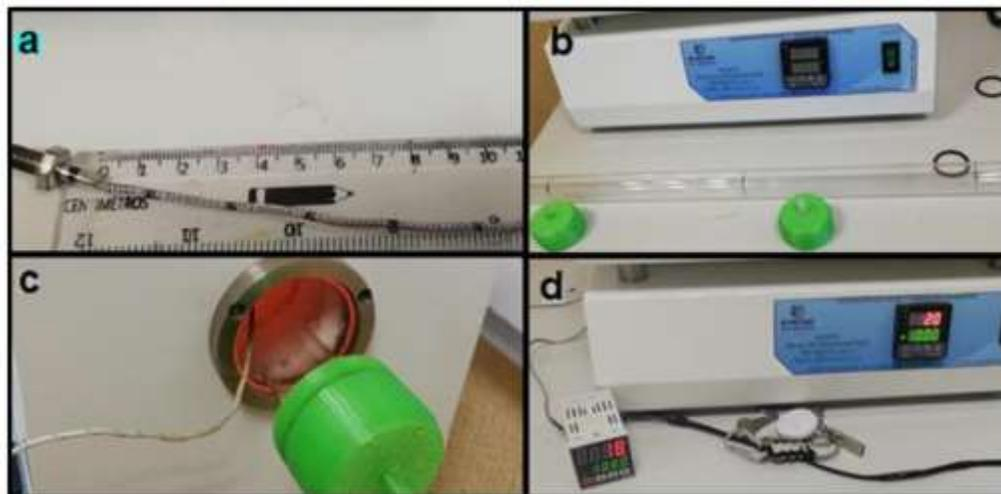
La zona de trabajo incluyó una región lineal de 10 cm, que es la que se considera como plana, donde la temperatura es uniforme y no hay un gradiente de temperatura importante que pueda afectar las propiedades del metal que se está oxidando (figura 6). La caracterización de la zona plana se basó en el estudio temperatura-distancia, el registro se plasmó en una tabla de valores. Estos intervalos se reflejan en la tabla 1
