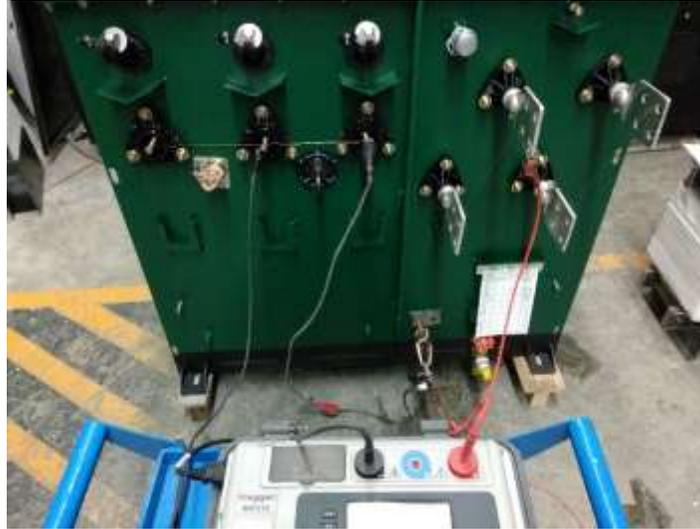
**Figura 26** Conexión Alta Tensión contra Baja Tensión más Tierra.
