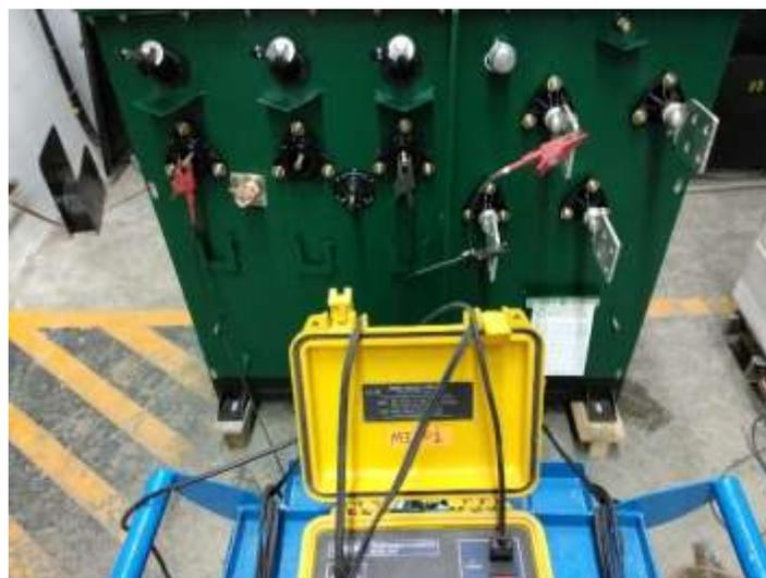
**Figura 15** Conexión para la prueba de relación de transformación en fase 2
