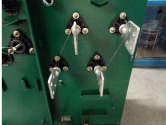
Las partes del ítem y los devanados que no se pongan a prueba deberán estar conectados a tierra como se muestra en las figuras 27 y 28.
