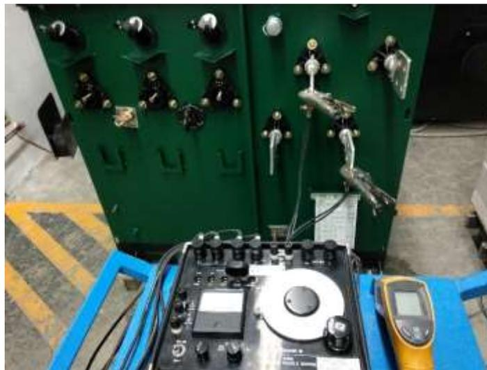
**Figura 20** Medición de Resistencia óhmica en lado secundario de  $X_1-X_3$
