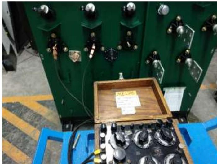
**Figura 23** Medición de Resistencia óhmica en lado primario de H<sub>1</sub>-H<sub>3</sub>.
