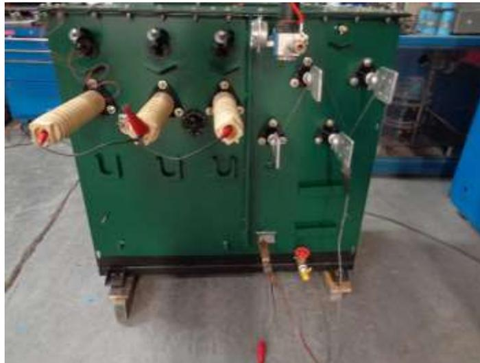
**Figura 31** Puesta a tierra del lado de B.T.
