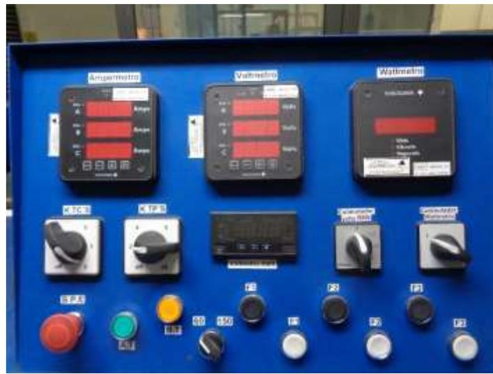
Como en esta prueba lo que vamos a obtener es la tensión nominal por el lado secundario, para ajustar la constante del T°C debemos saber la corriente por el lado secundario y obtener el 5% de esta para así tener la constante correcta.
