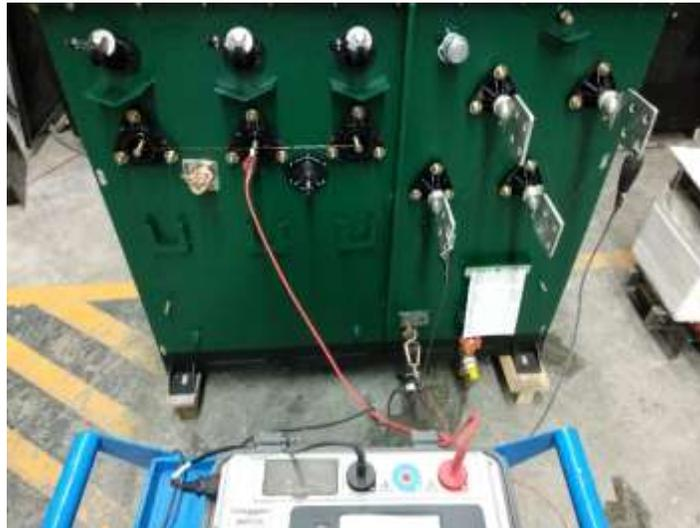
**Figura 27** Conexión Alta Tensión contra Baja Tensión sin Tierra.
