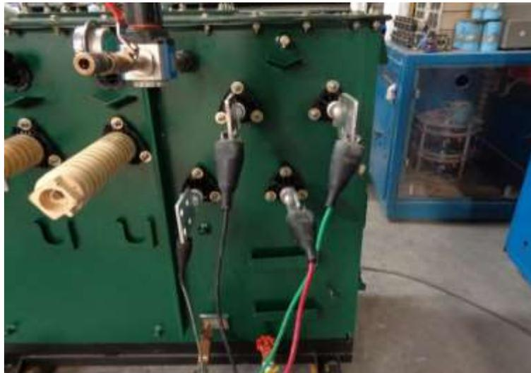
Una vez alcanzada la tensión en el ítem empezará a correr el tiempo correspondiente de acuerdo con la frecuencia de la tensión inducida en el ensayo.
