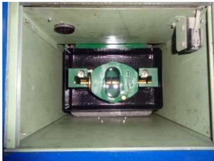
Pasado este tiempo de reposo se energiza el regulador de tensión al cual están conectados los electrodos de la copa, se va incrementando la diferencia de potencial entre los contactos de la copa y se observa cuando se da el arqueo, que es cuando se produce la ruptura del aceite, tomando en este momento la primera mensura y anotándola en el formato correspondiente (figura 44).
