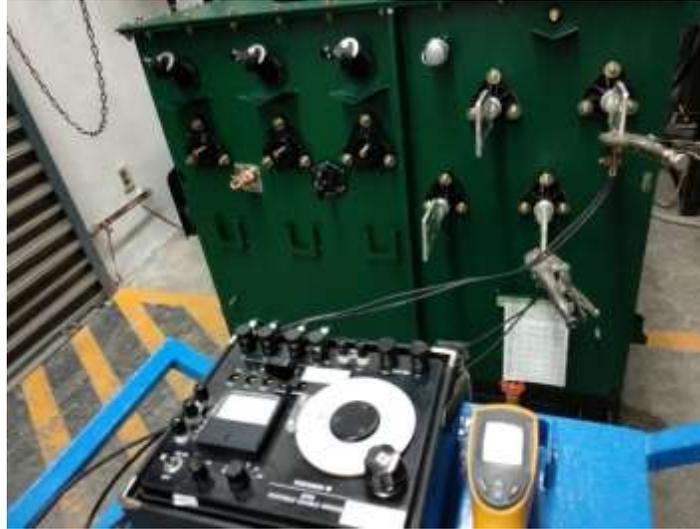
Ahora se procede a realizar la medición de Resistencia Óhmica por el lado primario.
