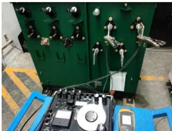
**Figura 21** Medición de Resistencia óhmica en lado secundario de X<sub>2</sub>-X<sub>3</sub>
