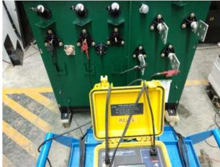
**Figura 16** Conexión para la prueba de relación de transformación en fase 3
