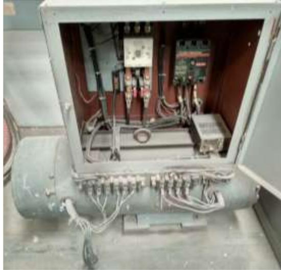
Se conecta el ítem para energizarlo ya sea por el lado primario o secundario, dejando los otros devanados en circuito abierto. Como se muestra en la figura 32 para el lado secundario.
