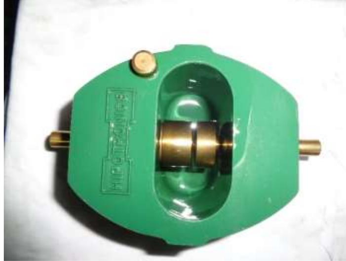
Se ajustan los electrodos con el perno patrón (figura 42).
