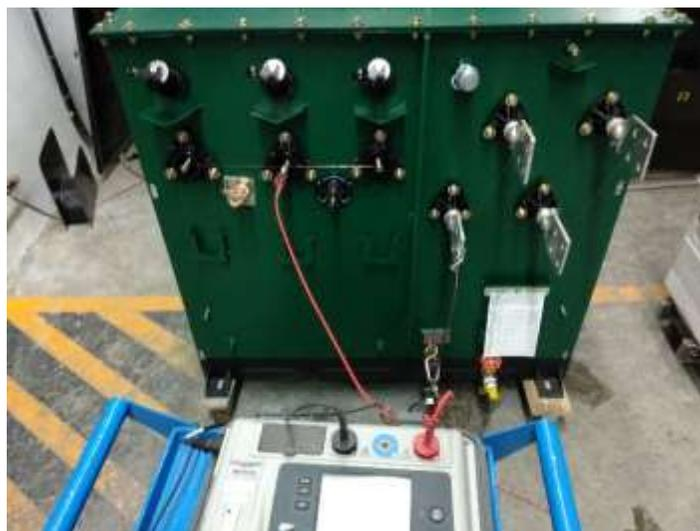
El tiempo para cada prueba es de 1 minuto, es el tiempo necesario para determinar si la clase de aislamiento tiene la calidad requerida, como mínimo el valor debe ser 200 M $\Omega$ .
