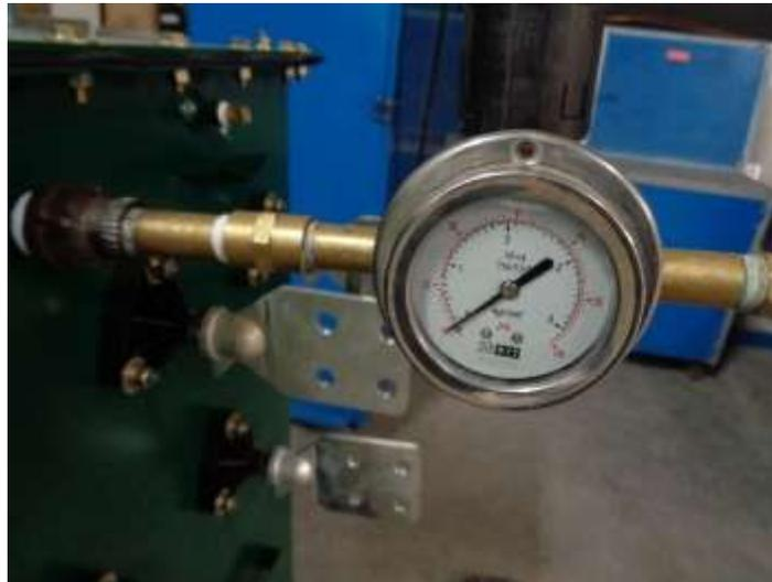
Cortar el suministro de nitrógeno o aire seco y dejar el tanque presurizado en reposo durante el tiempo establecido en la norma de producto correspondiente al tipo de transformador bajo prueba.
