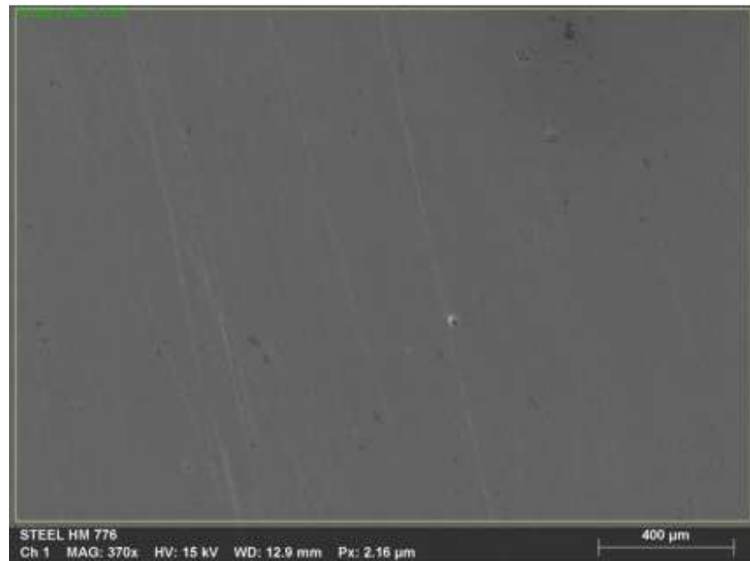
Figura 10 Micrografía por MEB de la microestructura del acero HM
