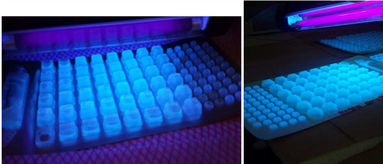
Figura 5 resultados de la muestra de agua mayo 2016 y octubre 2016-2017, Entero coli , al pasar la lampara de uv en un cuarto oscuro hay presencia de fluorescencia fuente propia
