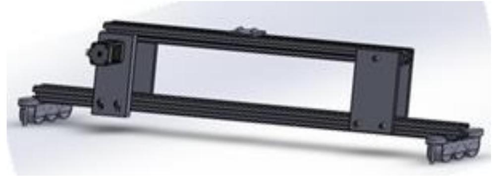
*Figura 4.* Ensamble del puente eje "Y"
