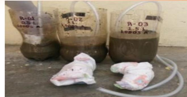
Reactores para prueba No. 1: Con lodos activados
