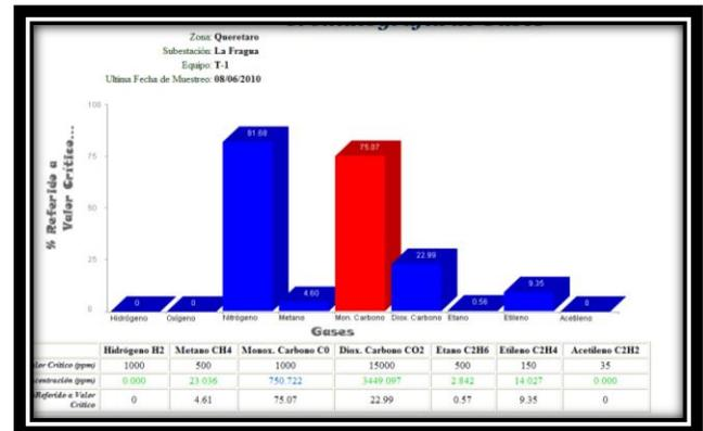
Gráfico 1 Reporte a grafico de barras obtenido mediante la cromatografía de gases
