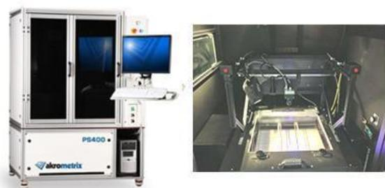
**Figura 3** Equipo TherMoiré PS400 con cámara de calentamiento.
