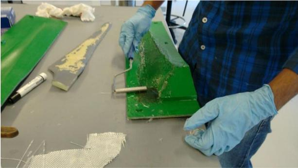
**Figura 3** Proceso de Manufactura de Aspas de Generador Eólico.
