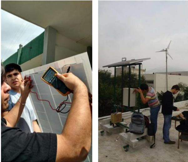
**Figura 7** Revisión de eficiencias y armado del sistema híbrido.
