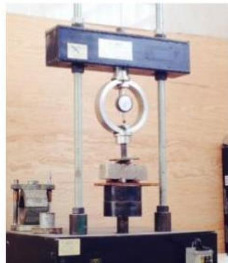
**Figura 4** Maquina para prueba de flexión
