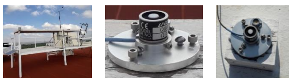
Figura 2 Sensor cuántico PAR y Estación Solarimétrica Zacatecas_04 ubicada en el edificio E6 de la UACQ del Programa Académico de Ingeniería Química del Campus Siglo XXI de la UAZ
