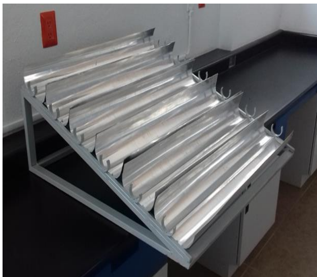
Figura 8 CPC construido y montado en soporte a 20° Fuente: Elaboración Propia
