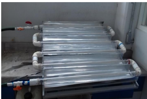
Figura 9 CPC con los tubos de acrílico montados Fuente: Elaboración Propia
