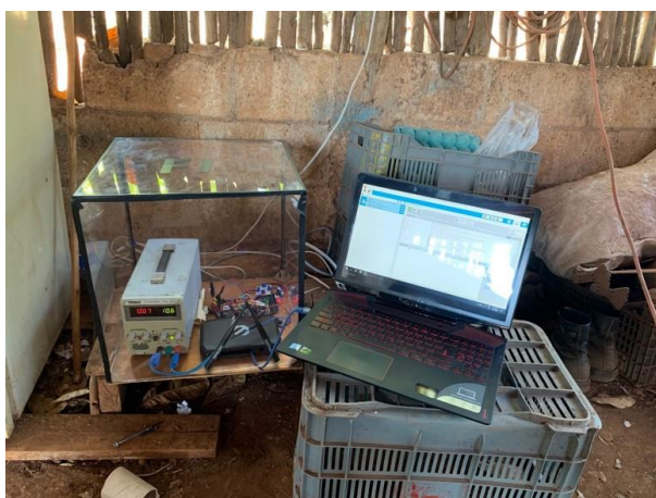
Figura 21. Repetidor RF y enlace GSM Fuente: Elaboración Propia, 2019
