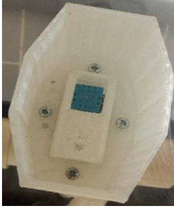
Figura 5 Encapsulados PETG impresos en 3D Fuente: Elaboración Propia, 2019
