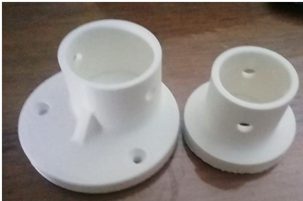
Figura 10 Soportes de molde inferior y superior en ABS Fuente: Elaboración propia
