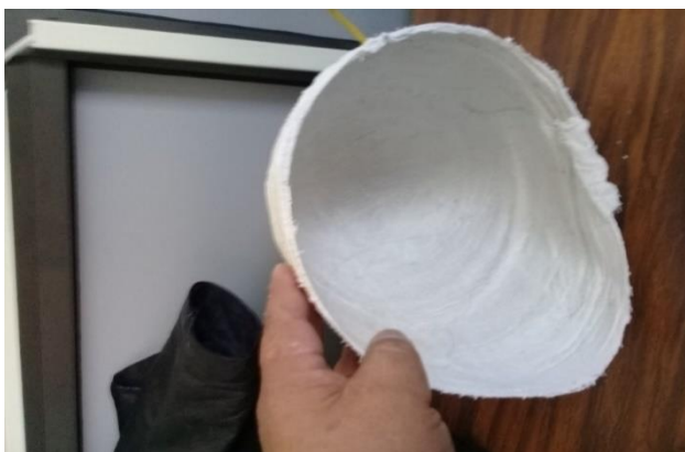
Figura 7 Molde primario en yeso Fuente: Elaboración propia
