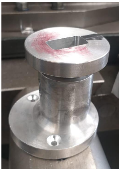
Figura 11 Soportes de molde inferior y superior en aluminio Fuente: Elaboración propia
