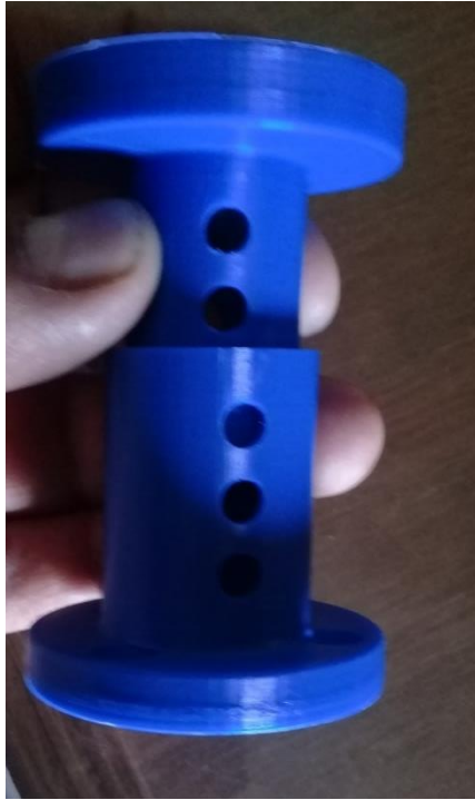
Figura 9 Soportes de molde inferior y superior en PLA Fuente: Elaboración propia
