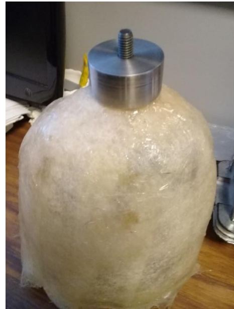
Figura 8 Espiga en molde de fibra de vidrio Fuente: Elaboración propia
