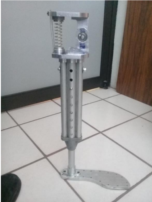
Figura 5 Prótesis para rodilla basada en Energía Cinética Fuente: Elaboración propia
