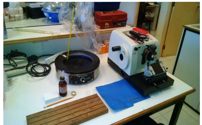
Figura 4 Equipamiento para el corte histológico y el montaje de los cortes de la piel y del ovario de los animales utilizados en los experimentos
