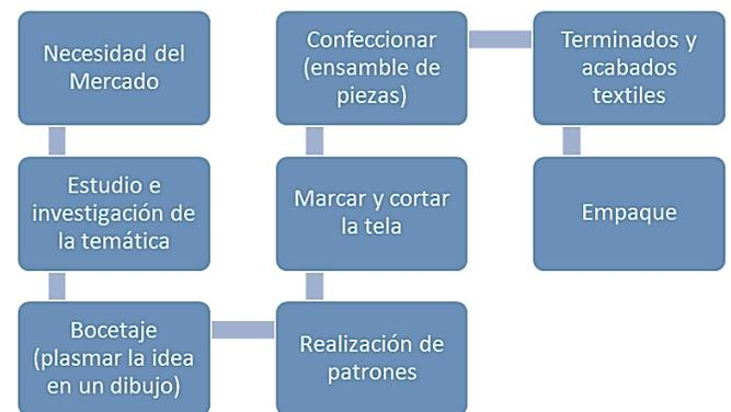
**Figura 1** Proceso de producción para la generación de una muestra. Fuente: *Elaboración propia*
