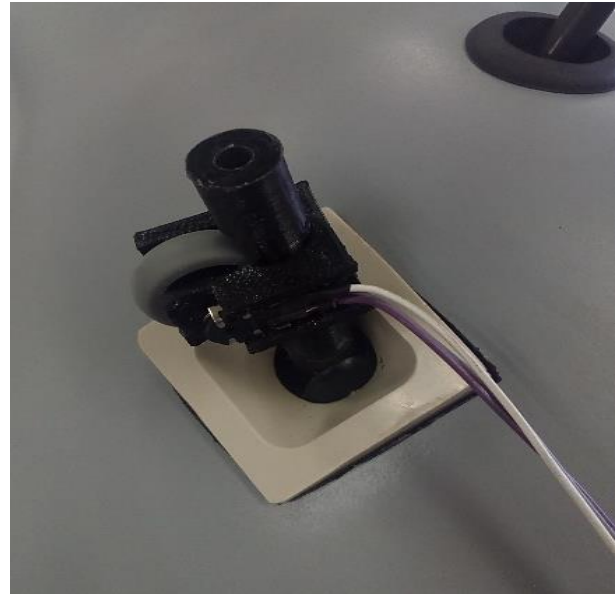
Figura 2 Colocación de codificador de cuadratura para lectura de eje Z
